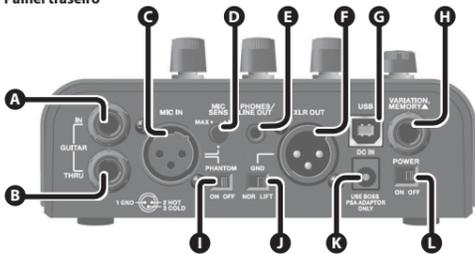
Este instrumento é equipado com conectores balanceados (tipo XLR). Veja abaixo os mapas elétricos para esses conectores. Só estabeleça as conexões depois de verificar os mapas elétricos dos demais equipamentos que pretende conectar.
